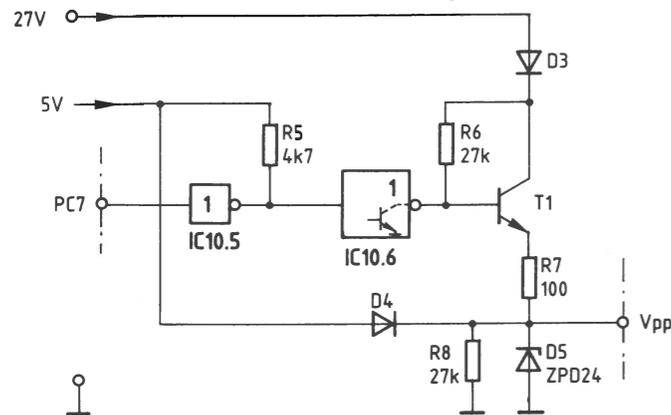
Bild 47: Der Programmierspannungs-Umschalter.
