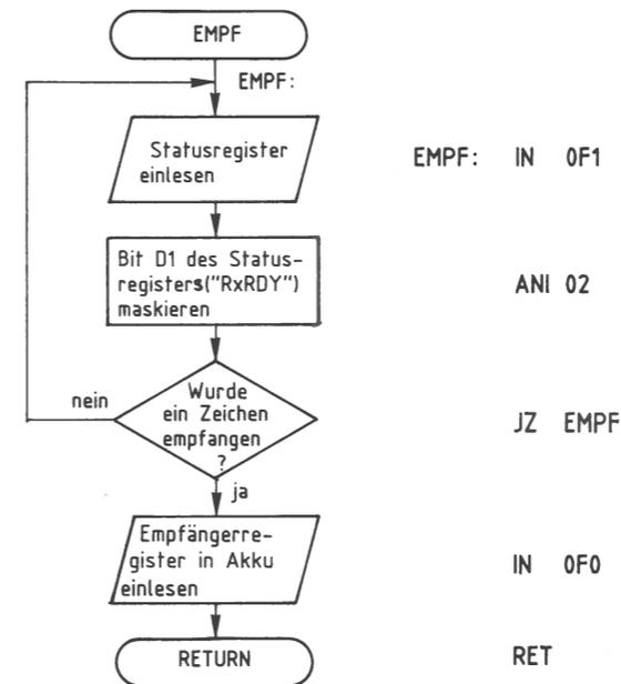
Bild 71: Flußdiagramm und Programm »EMPF« für den Datenempfänger.
