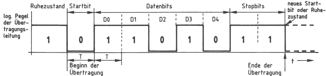
Bild 50: Die serielle Übertragung mit Start- und Stopbits.
