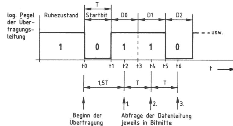
Bild 51: Die Abfrage der Datenleitung in der Bit-Mitte.
