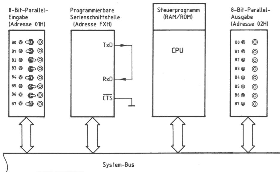
Bild 72: Der Aufbau zum Prüfen der seriellen Schnittstelle.
