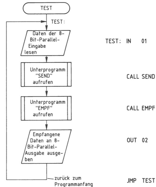
Bild 73: Das Testprogramm für die serielle Schnittstelle.
