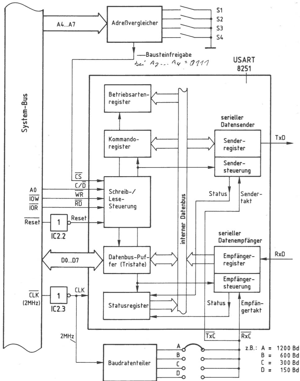
Bild 54: Das Blockschaltbild der Seriell-Baugruppe; die in den Bildern 74 und 75 (Seiten 446 ff.) vorgestellte Variante erlaubt bis zu 9600 Bd.
