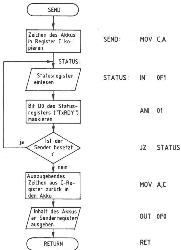
Bild 70: Flußdiagramm und Programm »SEND« für den Datensender.
